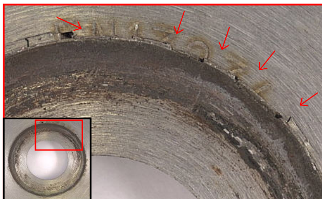
Flanșă de prindere uzată cu fisuri cauzate de torsiune - verschlissene Flanschaufnahme mit Torsionsrissen
