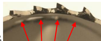
dinți îndoiiți, de exemplu din cauza tăierii lemnului cu noduri sau desprinderea violentă a zencuitorului
