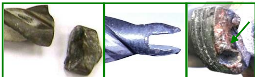
ruperea burghiilor cu carburi metalice - fehlende HM-Spitzen
