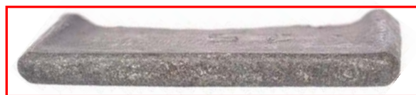
Daltă ruptă din cauza capului extrem de tocit - gebrochene Meißelspitze durch stark abgestumpfte Spitze
