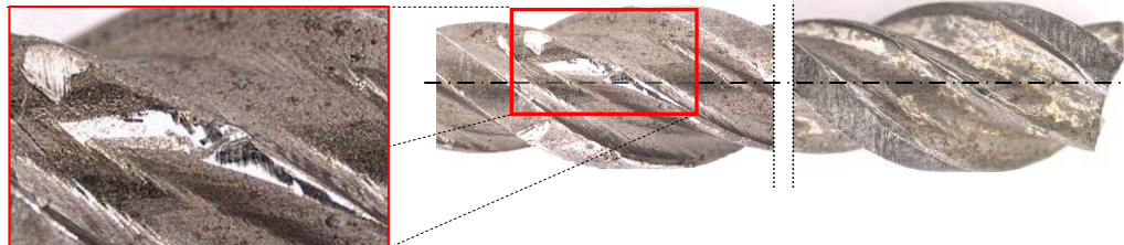
Lovituri și creștături pe suprafața unui burghiu defect -
