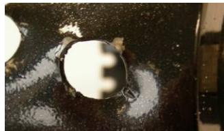
Semne de forțare pe orificiul de îndepărtare a prafului - Hebelmarken an Auswurföffnung
