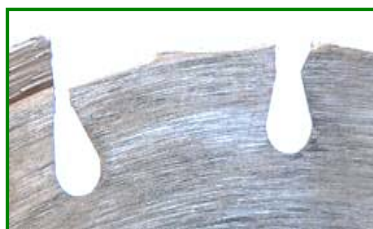
Segment lipsă, fără decolorare - fehlendes Segment, keine Verfärbung
