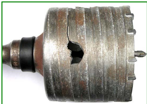
Gaură și crăpătură la 90° în petele burghiului - Loch und 90°-Bruch in der Wand
