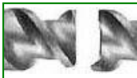
spirală ruptă la 90° - 90°-gebrochenes Gewinde
