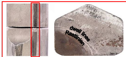
Rupere la oboseală a tijei, suprafață deteriorată - Ermüdungsbruch mit beschädigter Meißeloberfläche
