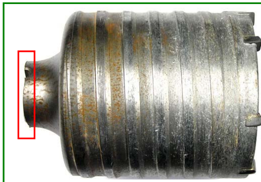
Tijă ruptă la 90°, la nivelul găurii pentru știftul de fixare - 90° Schaftbruch bei Querbohrung für Fixierstift
