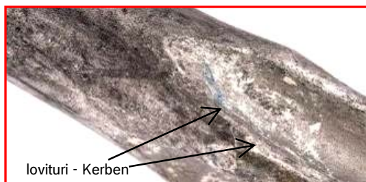
Suprafață deteriorată prin lovitură de ciocan - von Hammerschlägen beschädigte Meißeloberfläche
