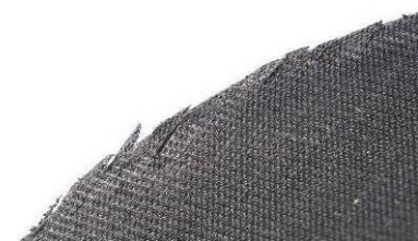
Placă de șlefuit uzată - verschlissener Schleifteller
