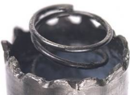
zencuitor uzat - verschlissene Lochsäge
