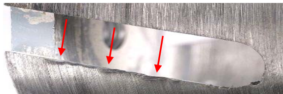
Semne de forțare pe orificiul de îndepărtare a prafului - Hebelmarken an Auswurföffnung
