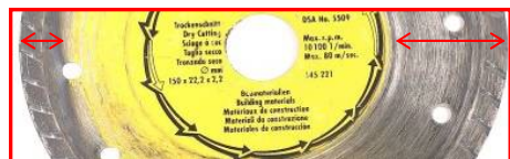
Disc îndoit cu uzură neuniformă - verbogene Scheibe mit ungleichem Verschleiß
