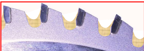
Spații interdentale umplute - gefüllte Zahnzwischenräume
