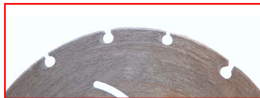
Uzură uniformă la nivelul tuturor segmentelor -
