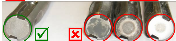
Suprafață polizată a tije și zonă de impact - polierte Schaftoberfläche und Schlagfläche
