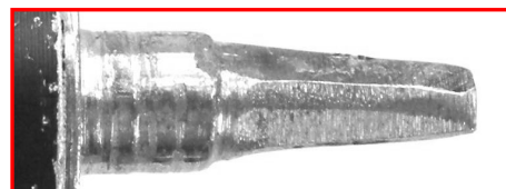
Tijă hexagonală modificată (polizată) - manipulierter (nachgeschliffener) 6-Kantschaft
