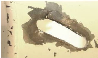
Semne de forțare pe orificiul de îndepărtare a prafului - Hebelmarken an Auswurföffnung
